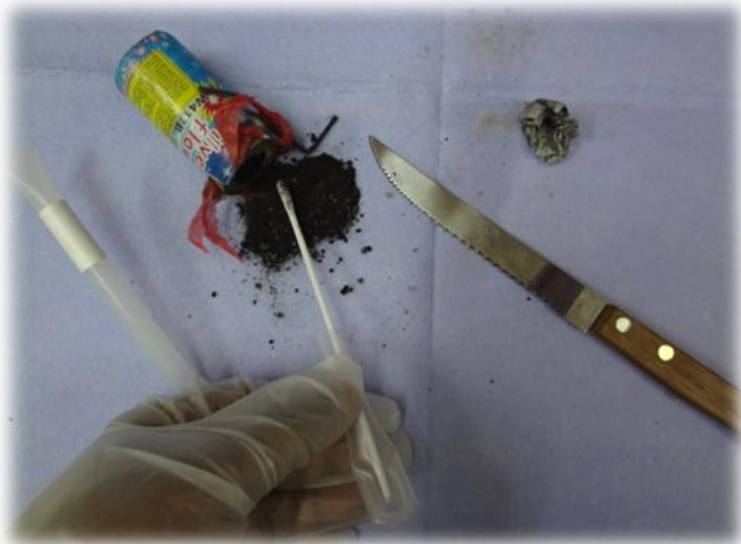
Figuur 22 Het bemonsteren van vuurwerk middels swabs
