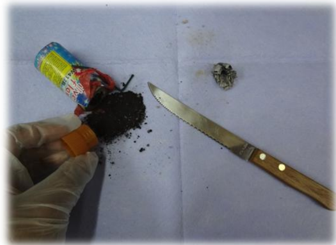
Figuur 23 Het bemonsteren van vuurwerk middels stubs Blanco
